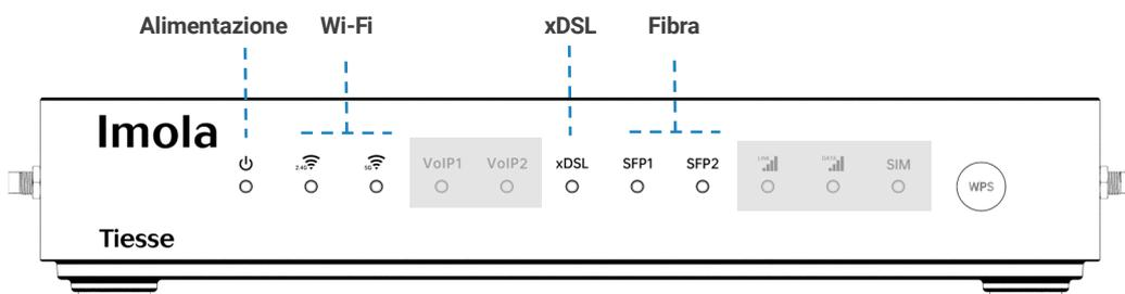
\* NOTA: L'utilizzo dei LED dipende dalle funzionalità attive di ciascun modello specifico. Nella figura sopra sono evidenziati i LED utilizzati nei modelli oggetto di questo datasheet.
