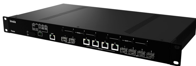
Esempio di Imola 0286 con staffe per montaggio su rack 1 U.
